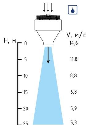
Завеса с осевыми вентиляторами, состоит из набора жестко скрепленных стандартных модулей. Изготавливается из оцинкованной или нержавеющей стали. Устанавливается горизонтально или вертикально, под любым углом к плоскости проема (в соответствии с проектом). Угол наклона обеспечивает кронштейн, изготовленный по предварительному заказу (в комплекте). Щит управления с частотным регулятором (опция).
