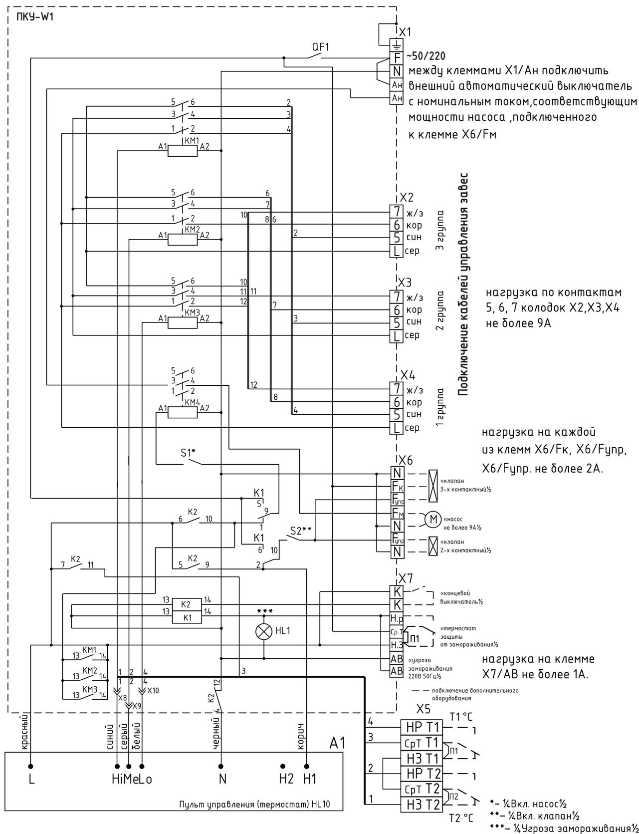
Электрическая схема Блока E
