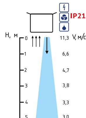
Завеса предназначена для скрытой установки за подвесным потолком. Передняя панель изготовлена из окрашенной стали светло-серого цвета RAL7035. Сервис и обслуживание осуществляется через переднюю панель завесы. Пульт управления HL10 в комплекте.
