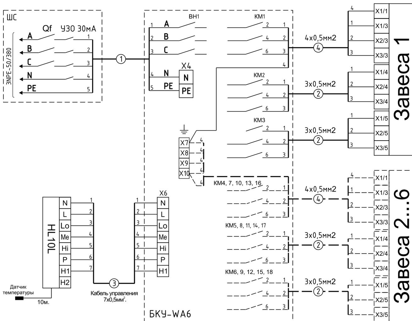
При подключении нескольких завес к одному БКУ цепи термозащиты двигателей завес должны быть соединены последовательно. Схема соединений для шести завес представлена на рисунке ниже.
