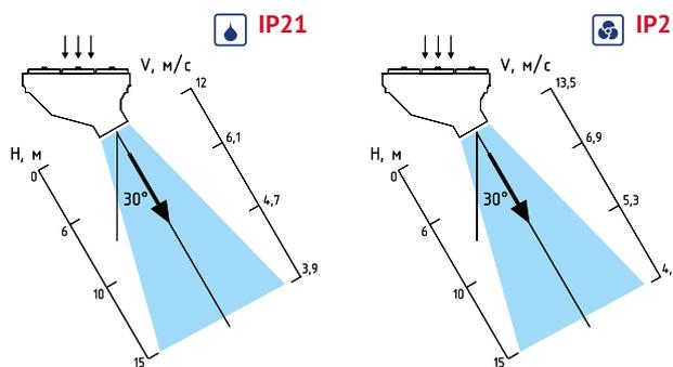
Завеса из оцинкованной стали с осевыми вентиляторами. Устанавливается горизонтально или вертикально. Угол к плоскости проема 30° обеспечивается установленным углом сопла. Пульт HL10 и кронштейны в комплекте.
