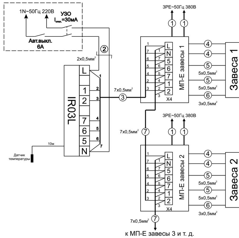
Рис. 2. Электрическая схема модулей МП-Е (МП12-24Е, МП36-48Е, МП60Е)
