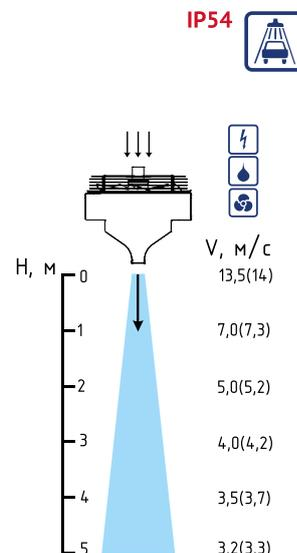
Завесы из оцинкованной или нержавеющей стали с осевыми вентиляторами.
