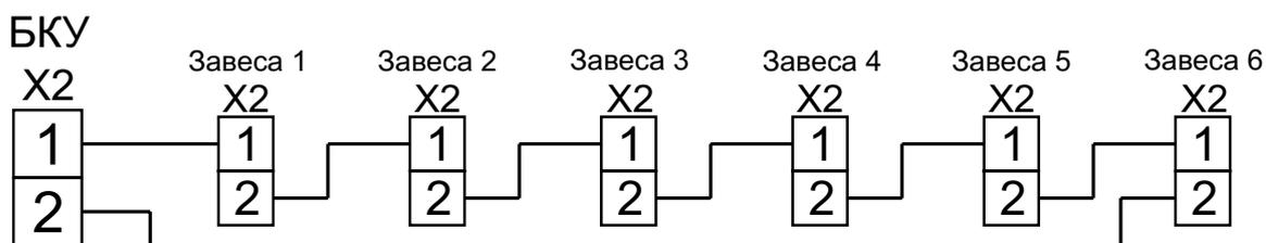
При меньшем количестве завес контакт х 2/2 последней завесы соединяется с контактом х2/2 БКУ.
