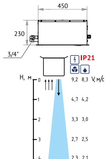
Завеса предназначена для скрытой установки за подвесным потолком. Передняя панель изготовлена из окрашенной стали светло-серого цвета RAL7035. Сервис и обслуживание осуществляется через переднюю панель завесы. Пульт управления HL10 в комплекте.
