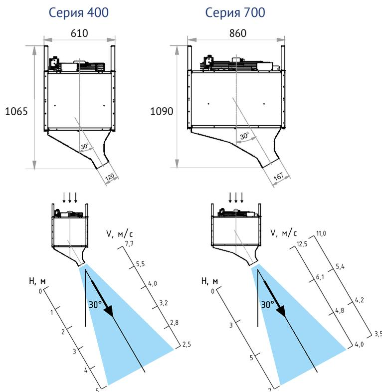
Завеса с осевыми вентиляторами, из оцинкованной стали с белым полимерным покрытием. Автоматика газовой горелки завесы обеспечивает защиту воротного проёма и даже при низких температурах воздуха гарантирует небольшие эксплуатационные расходы. Завеса работает на природном газе G20 или пропане G31.
