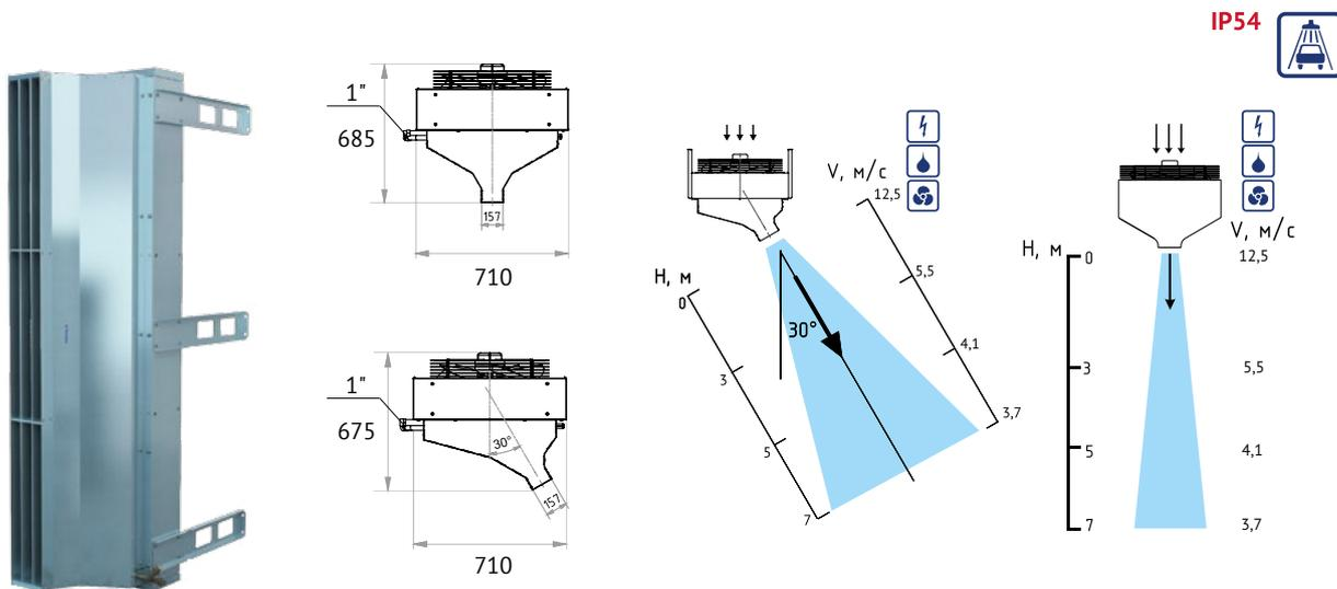
Завесы из оцинкованной или нержавеющей стали с осевыми вентиляторами, стандартный угол сопла – 0°, под заказ – 30°. Монтажные кронштейны в комплекте. Управление завесами водяными и без нагрева осуществляется модулями МП-WA или БКУ-WA6, а электрическими завесами - МП-Е, см. раздел управление.
