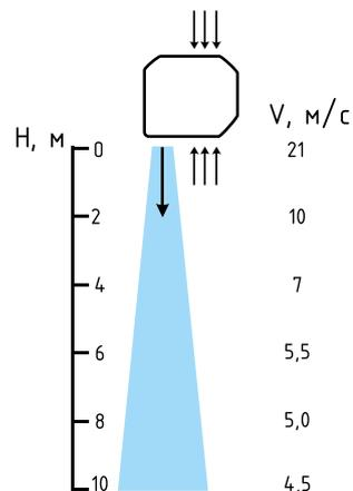
Завеса из оцинкованной стали с центробежными вентиляторами, состоит из набора жестко скрепленных стандартных модулей. Устанавливается горизонтально или вертикально под углом к плоскости проема. Угол кронштейна заказывается согласно проекту. Пульт HL10 в комплекте.
