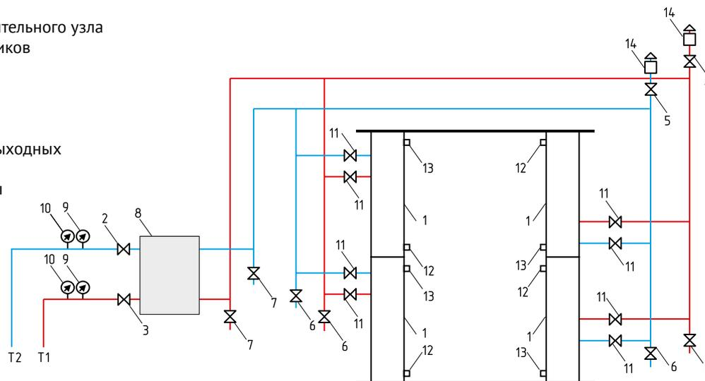
Завесы оснащены воздухонагревателем, имеющим два выпускных клапана 12 и 13. Это допускает любую ориентацию воздухонагревателя по вертикали.
