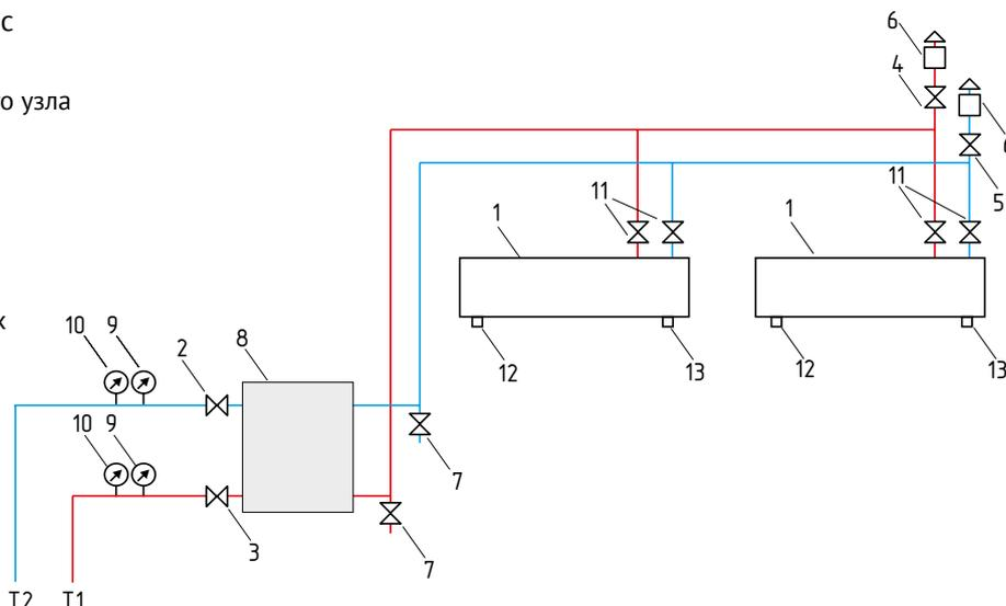
Требуемый расход воды устанавливают балансировочным вентилем на прямой магистрали перед смесительным узлом (на схемах не показан). При аварийном отключении теплоснабжения на срок, опасный в плане разморозки воздухонагревателей, следует закрыть краны 2 и 3 и открыть все сливные краны 6 и 7, а также 12 и 13.
