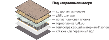
Рис. Схема монтажа теплого пола CALEO под ковролин или линолеум
